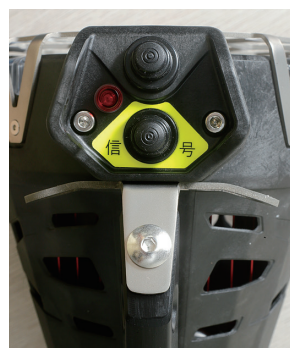
モード切替えボタンと信号連絡ボタンを縦に並べて手元に集約。
